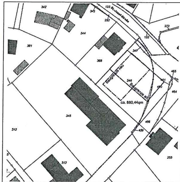
Abb. 3: Geplante Änderung der bebaubaren Fläche im Bereich von Flurstück 346
